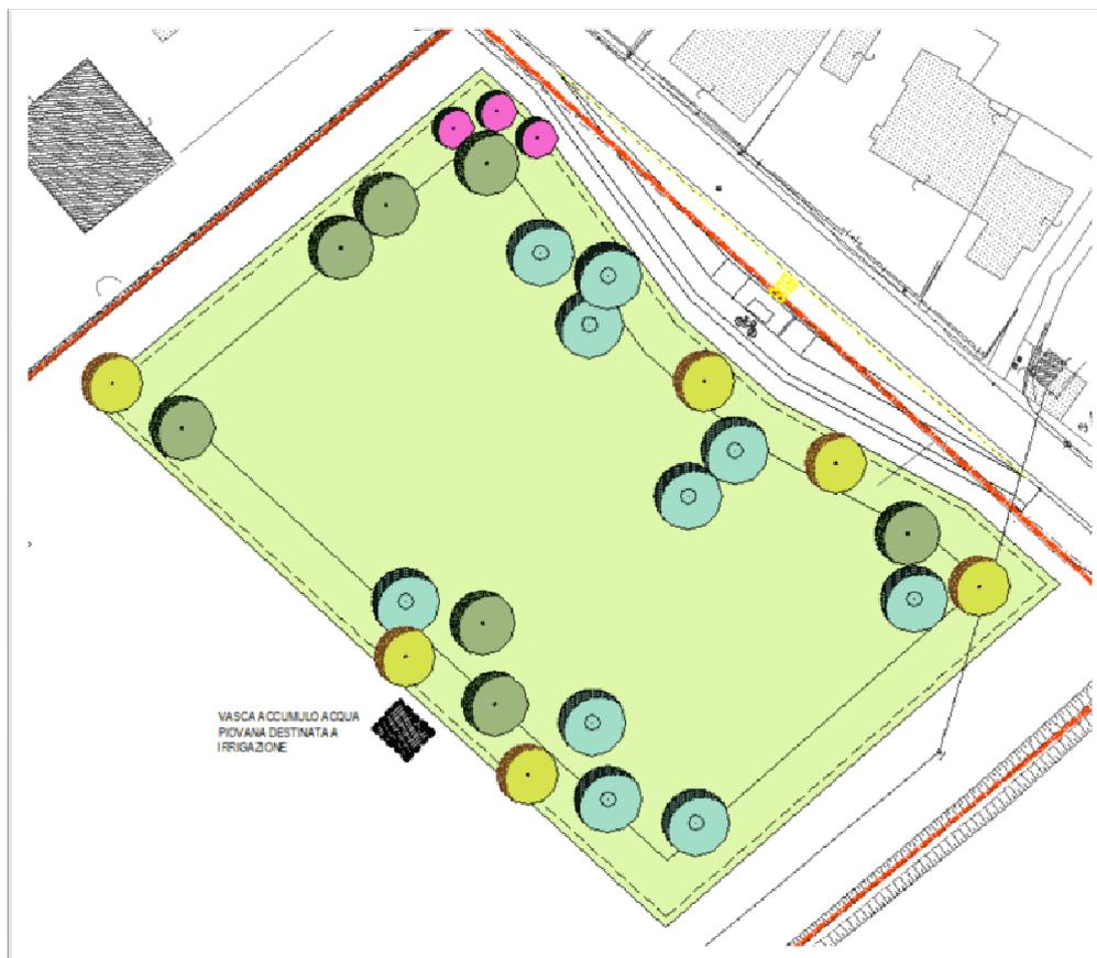
Figura 5 - localizzazione della vasca di accumulo presso l'area di laminazione
